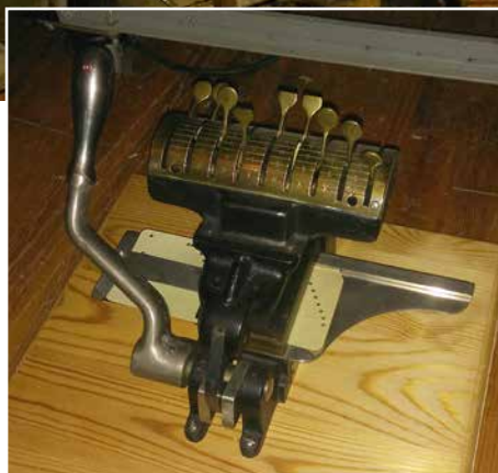
Hollerith – lävistin vuodelta 1900. Kortissa on 45 saraketta ja pyöreät reiät.
